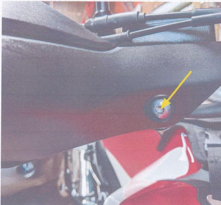
4. Die beiden Kreuzschlitzschrauben der Schaltereinheit lösen und entfernen:
