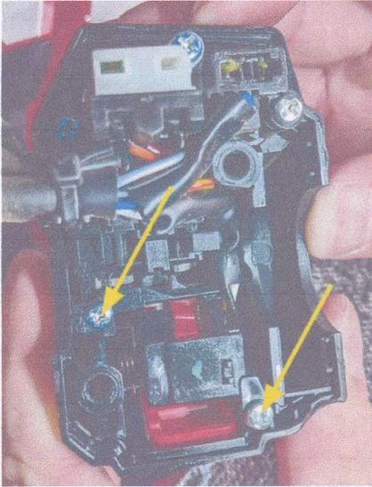
7. Leitung aus Klemmung lösen:
